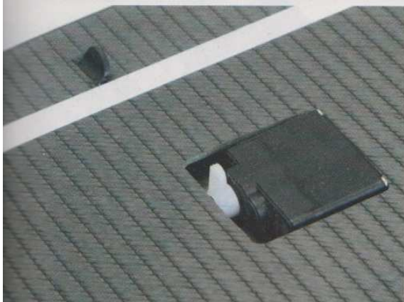
Das Servo passt genau in den präzise ausgefrästen Einbauplatz
