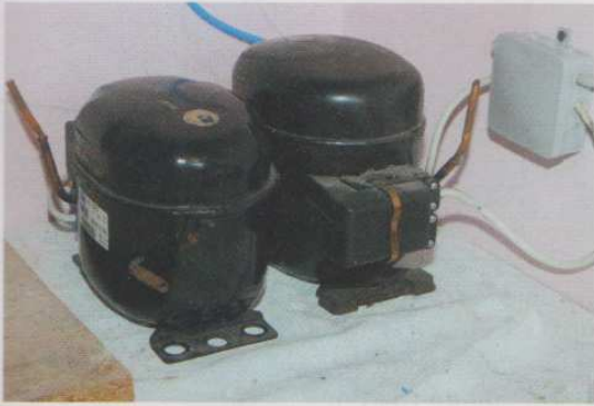
Das für den Herstellungsprozess des Apus notwendige Vakuum wird mit ausrangierten Kühlschrankkompressoren hergestellt
