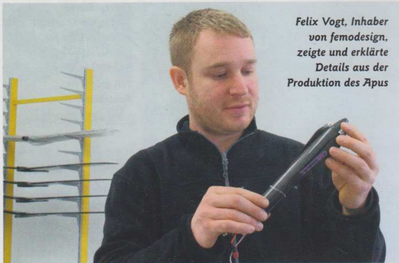
Eine Kohle-Keular-Rumpfspitze dient zum reinen Seglerbetrieb. Durch Austauschen der Spitze wird der Apus zum Elektrosegler
