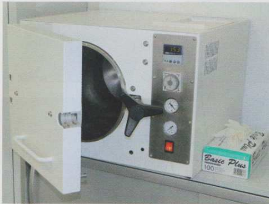
Der Autoklav ist an eine Vakuumpumpe angeschlossen und dient zur Herstellung kleinerer CFK-Bauteile
