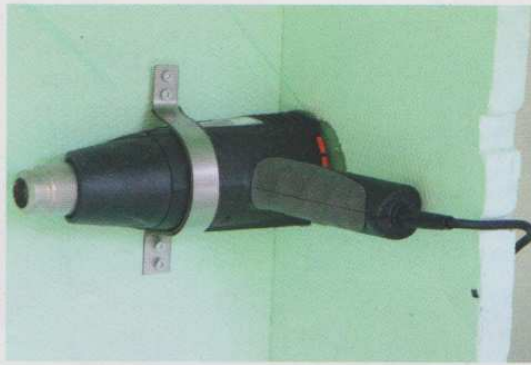
Ein regelbares Heißluftgerät wärmt die Isolierkiste für die thermische Nachbehandlung von größeren Bauteilen
