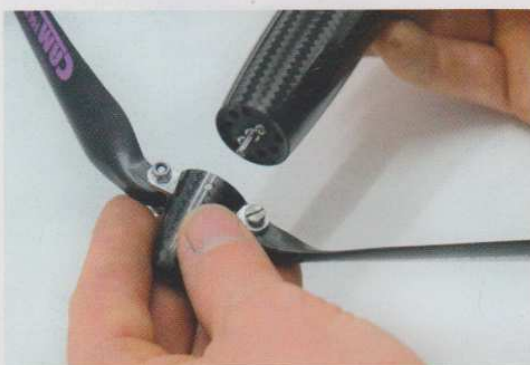
Endmontage des vorbereiteten Klapppropellers
